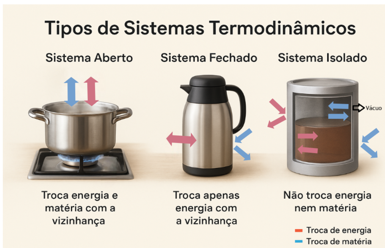
Figura 1: Diagrama ilustrativo dos três tipos de sistemas termodinâmicos, destacando as trocas de energia e matéria.
